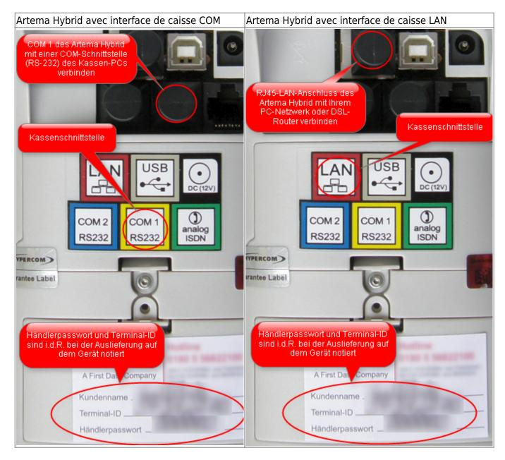
Les connexions d'un Artema Hybrid sont représentées ici. Sur votre terminal, la disposition des interfaces est éventuellement différente.
