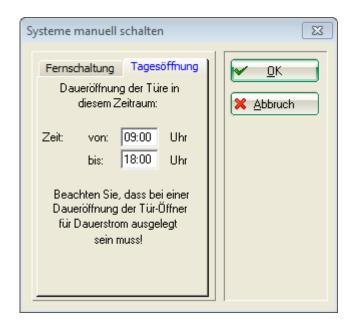
Veuillez noter qu'en cas d'ouverture permanente, l'ouvre-porte doit être conçu pour un courant permanent.
